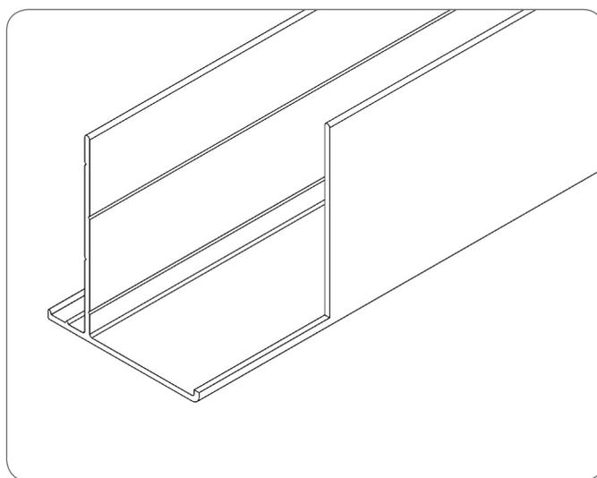
Les marqueurs situés à l'extérieur du profil déterminent la hauteur de rivetage en fonction de la position du profil par rapport à l'adaptateur de fixation **AWNT**.
