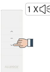
Die AB-Taste betätigen was mit einem Tonsignal bestätigt wird (x1 BIP)
