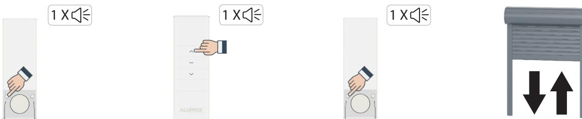
Drücken Sie bitte die Taste „P2“ des Senders, dieses wird Ihnen durch einen kurzen Piepton bestätigt (x1 BIP).
