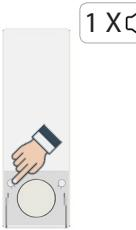
Drücken Sie bitte die Taste „P2“ des Senders, dieses wird Ihnen durch einen kurzen Piepton bestätigt (x1 BIP).
