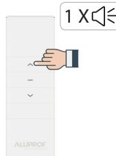
Drücken Sie bitte die Taste „AUF“ des Senders, dieses wird Ihnen durch einen kurzen Piepton bestätigt (x1 BIP).
