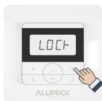
Lors de l'activation de la fonction de blocage des claviers, un quelconque appui sur les boutons de l'émetteur affichera le message « LOCK » sur l'afficheur.
