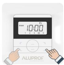
Maintenir simultanément les boutons « MODE/ K- » et « OK/K+ » pendant 3 secondes active la fonction de blocage des claviers de l'émetteur.
