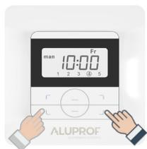
Durch gleichzeitiges drücken der MODE / K- und OK / K+ - Tasten für 3 Sekunden wird die Sperrfunktion der Sendertasten aktiviert.
