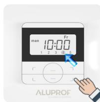
Die OK / K + - Tasten 3 Sekunden lang gedrückt halten, die Ziffer des deaktivierten Kanals blinkt.
