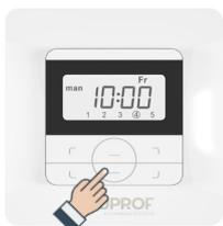
Die P2-Taste 3 Sekunden lang gedrückt halten. Der Modus wird geändert.
