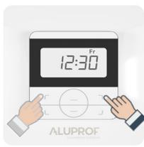
Durch drücken der AUF- oder AB-Tasten können die Minuteneinstellungen geändert werden.
