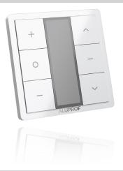
Stromversorgung:3V (1 X CR2430)Frequenz:433.92 MHzSendeleistung:10 miliwat (mW)Betriebstemperatur: $\sim -10^{\circ}\text{C} - \sim +55^{\circ}\text{C}$
