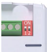
Interrupteur 2 est en charge du changement de direction de fonctionnement des boutons de commande.
