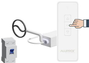
Bei eingeschalteten Funkzentrale die STOP-Taste gedrücken halten
