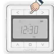
Die SET-Taste 3 Sekunden lang gedrückt halten, bis das Blinken der Symbole auf dem LCD aufhört, was bedeutet, dass die Änderungen an den Einstellungen gespeichert wurden.
