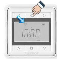
Die SET-Taste 3 Sekunden lang gedrückt halten, bis das Blinken der Symbole auf dem LCD aufhört, was bedeutet, dass die Änderungen an den Einstellungen gespeichert wurden.
