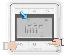
Durch drücken der AUF- oder AB-Tasten kann die Betriebsart gewechselt werden.
