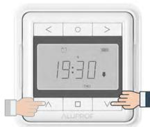
Durch drücken der AUF-Taste wird der Kanal aktiviert. Durch drücken der AB-Taste wird der Kanal deaktiviert.
